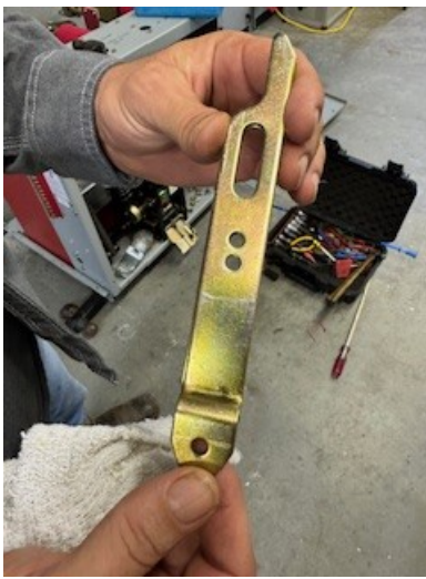
Bent interlock arm
