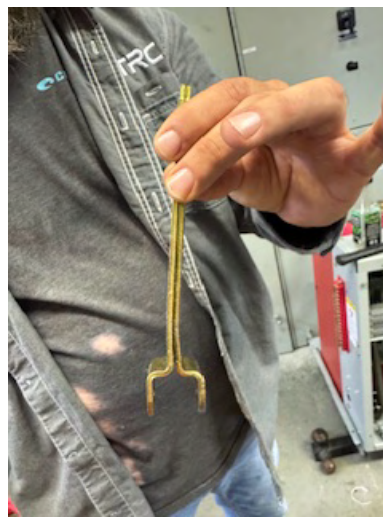
Bent interlock arm
